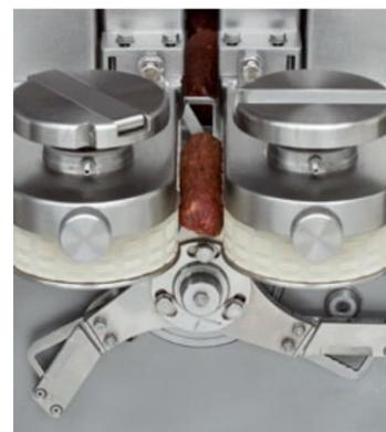
WT 99 DS - Die INOTEC Doppelschneidemaschine mit Doppel- und Gegenmesser zum Herausstrennen von Abdrehtellen (3-10 mm) und mit entsprechenden Topplatten auch für Cocktailwürstchen (Warenlänge ab ca. 25 mm).
