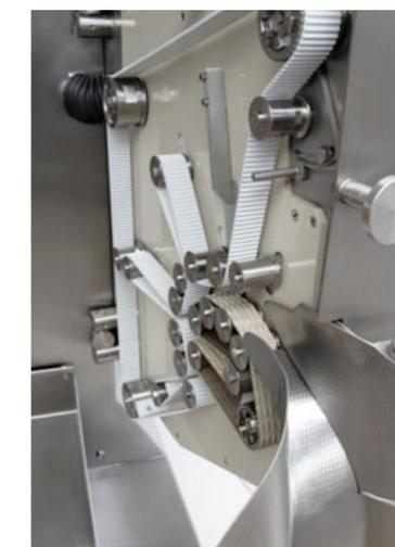
INOTEC WT 97 SH - die Trennmaschine wurde speziell entwickelt für gebogene Würstwaren im Natur-, Collagen- und Kunstdarm. Nur die kreisförmige Produktführung ermöglicht das Schneiden von stark gebogener Ware. Ein Spezialmesser in Verbindung mit der WT 97 SH ermöglicht bei bestimmten Wurstsorten das gleichzeitige Schneiden und Entclippen von Einzelclips.
